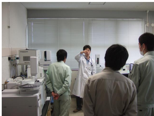
これはホルムアルデヒド等を前処理後（溶媒抽出－誘導体化）に測定する、ガスクロマトグラフ質量分析計です。
