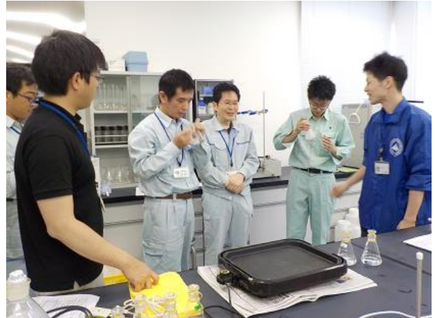
臭気検査実習：検水を共栓付き三角フラスコに採り、40～50℃に温め、振り混ぜます。
